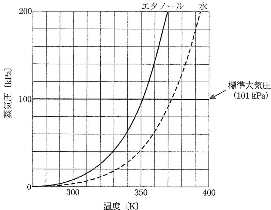
図4 水とエタノールの蒸気圧曲線
