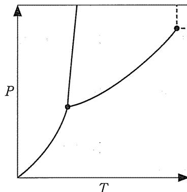
図1 二酸化炭素の状態図(概要)
