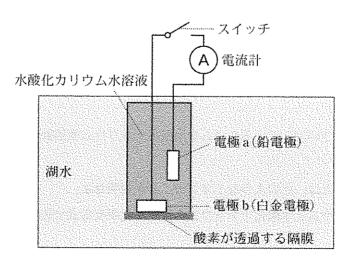
図1 溶存酸素計の構造
